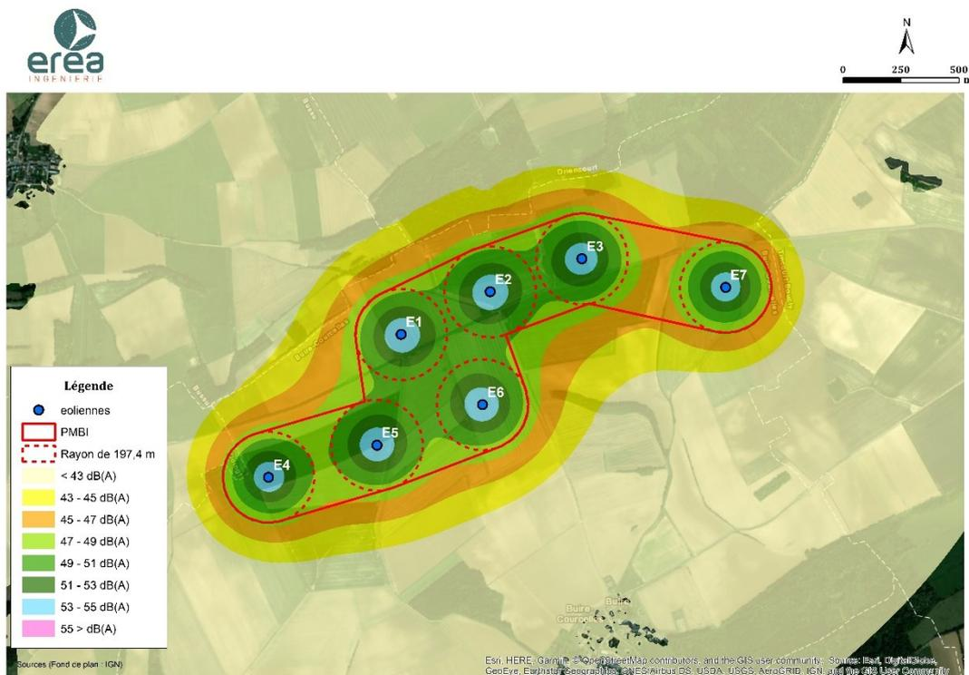
*Isophones au périmètre de mesure du bruit de l'installation – Configuration V117*
