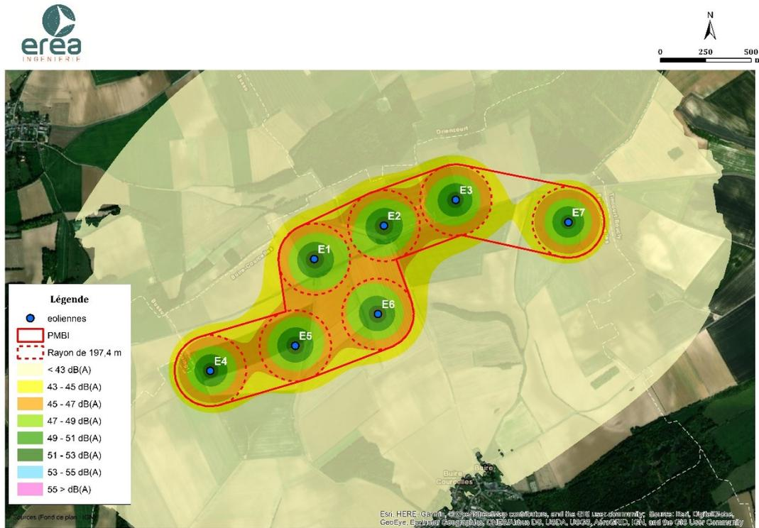
*Isophones au périmètre de mesure du bruit de l'installation – Configuration N117*
