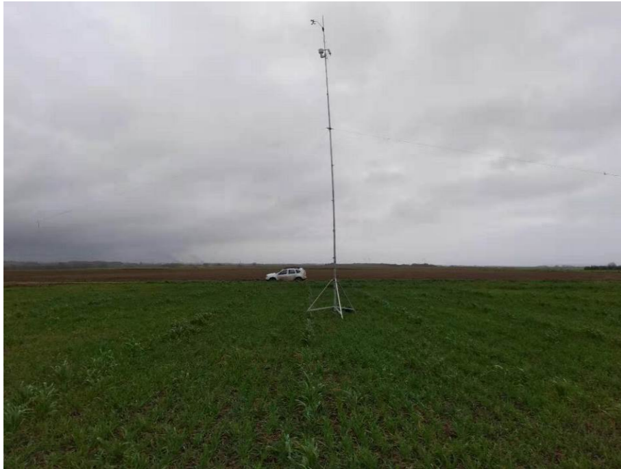
Figure 4. Implantation du mât de mesure de vent
