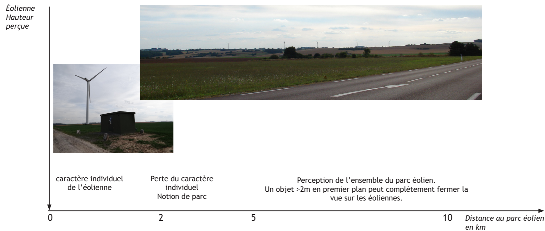
Schéma 8. Lecture d'un parc éolien en fonction de la distance
