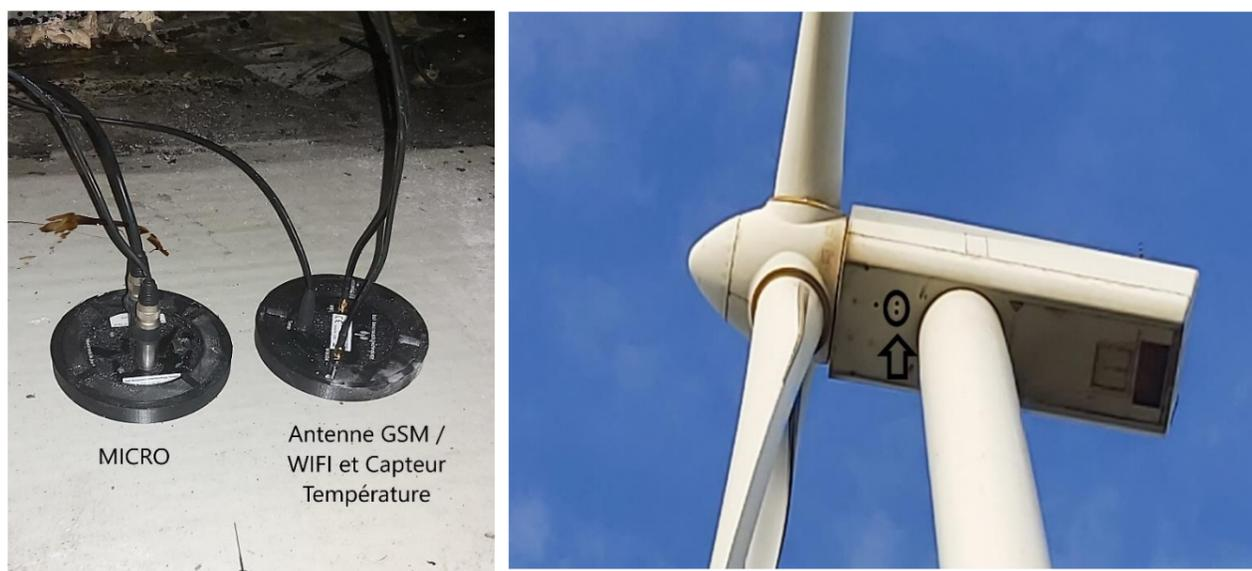
Figure 106 : Configuration de l'installation du BATmode en nacelle
