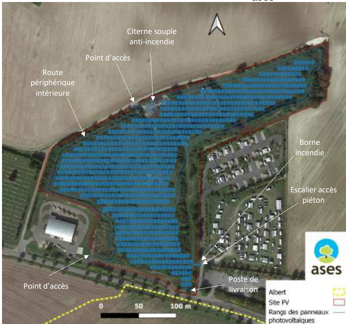
Figure 2 : Plan de calepinage du projet sur le site et équipements annexes.
