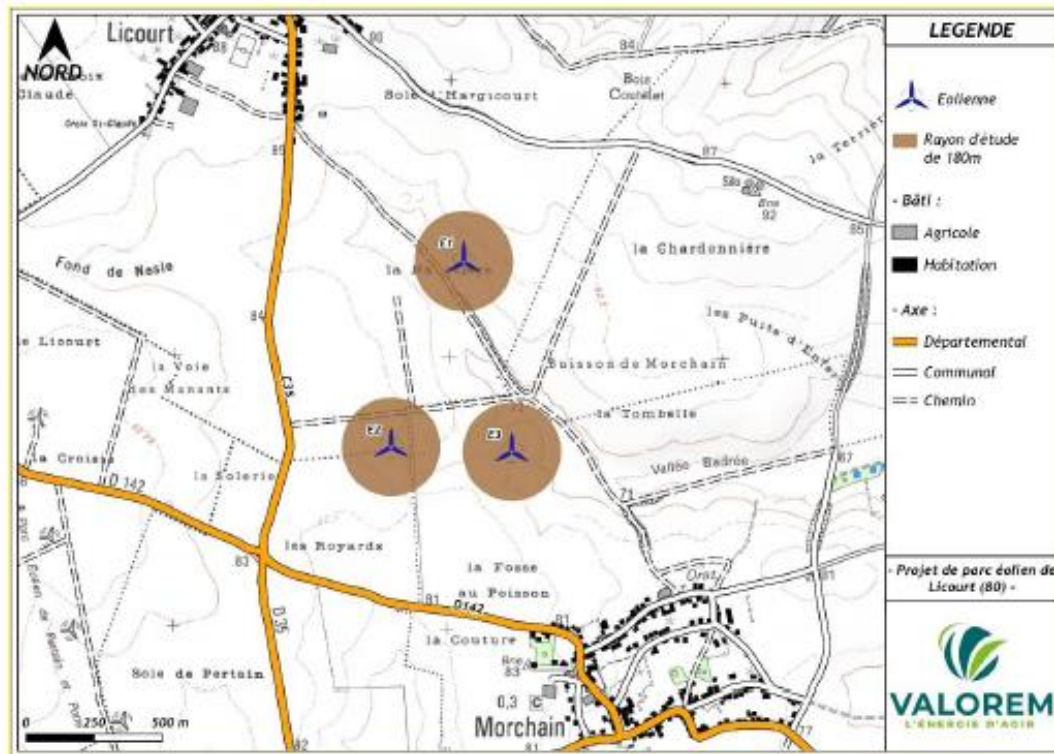
Zone d'effet du phénomène « Effondrement de l'éolienne »
