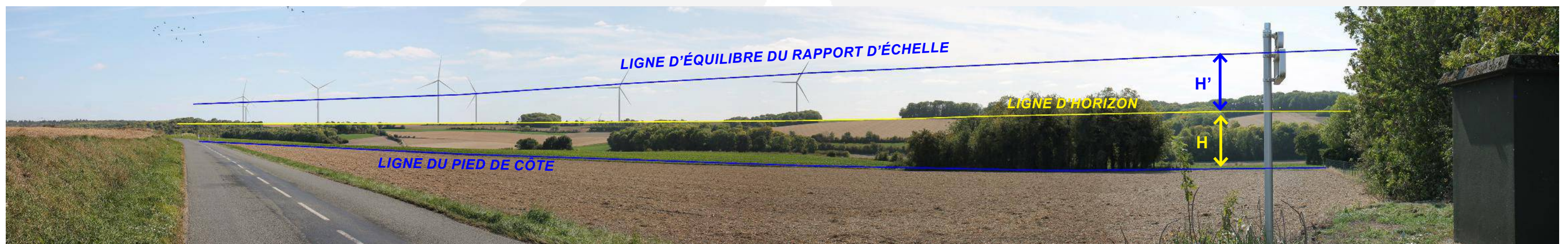
Analyse du rapport d'échelle. Pour obtenir un rapport d'échelle acceptable la dénivelée «H» doit être au moins supérieure ou égale à «H'». Ici le rapport est défavorable pour 6 éoliennes.
