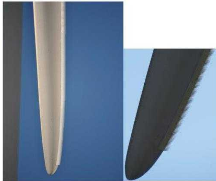
Figure 234 : Illustrations de peignes sur les pales d'une éolienne (source : EREA Ingenierie, 2019)
