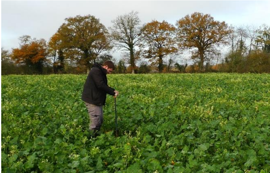
Prélèvement à l'aide d'une tarière pédologique - Calidris
