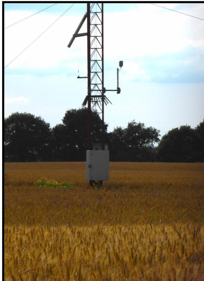
**Photo n° 5 : Détecteur d'ultrasons dans son caisson de protection sur le mat de mesure.**
