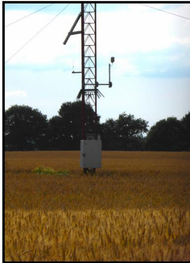
Figure 343 : Détecteur d'ultrasons dans son caisson de protection sur le mât de mesure (source : Philippe Lustrat, 2018)
