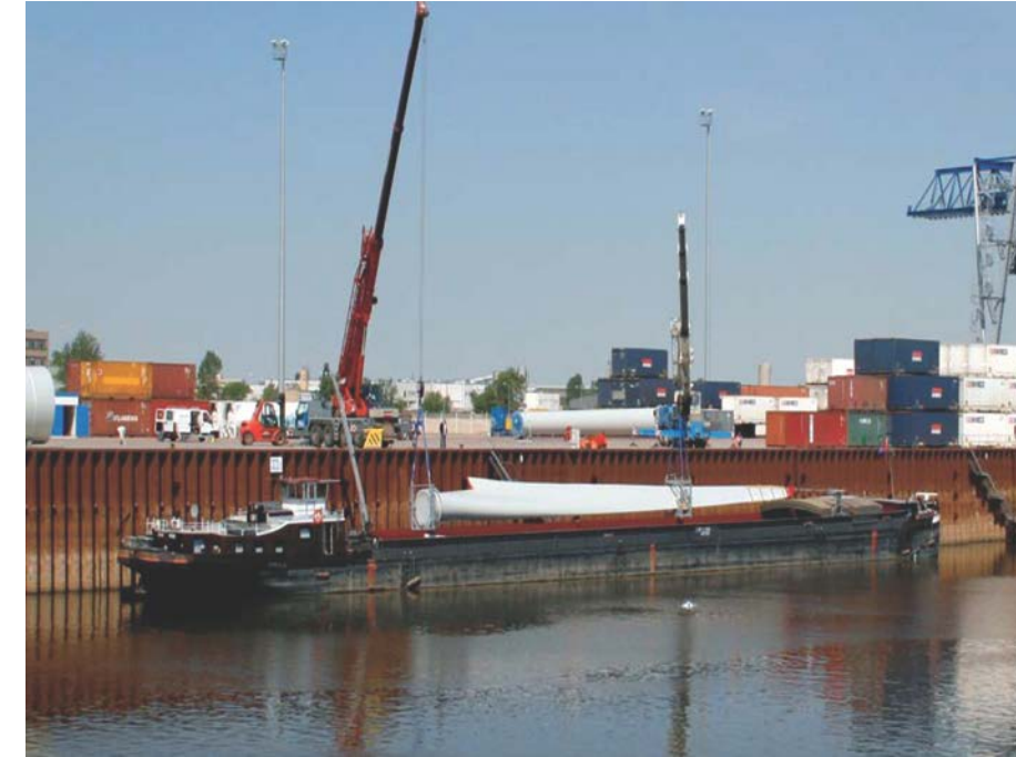
Figure 104 : Acheminement d'une pale par bateau (source : Enercon, 2015)
