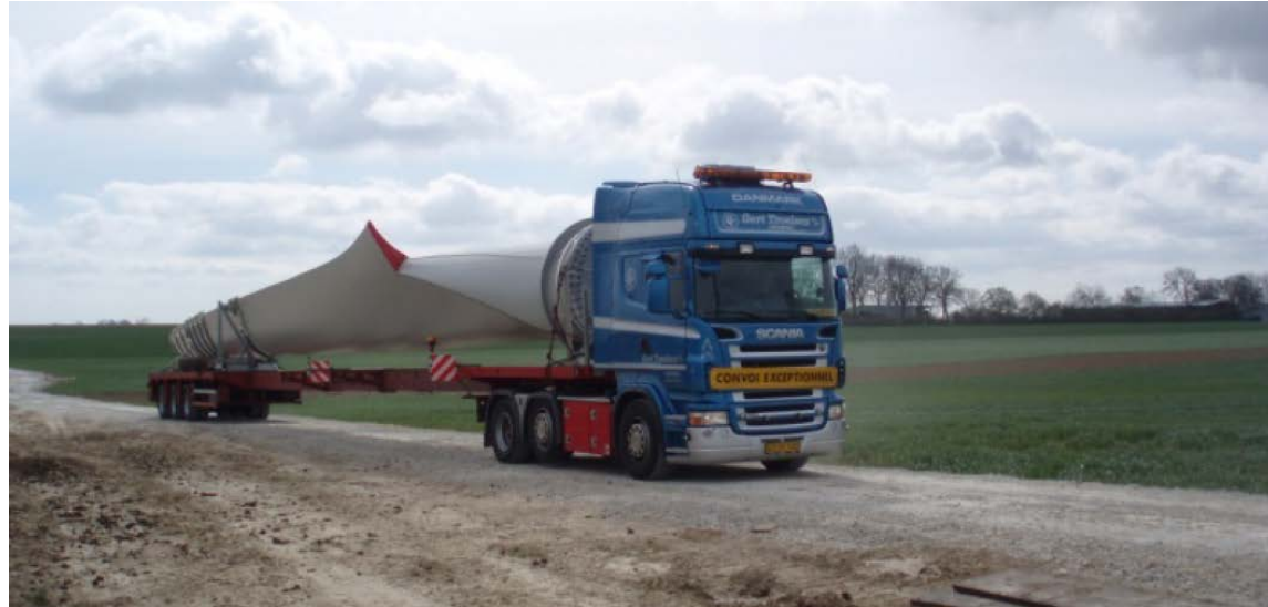
Figure 103 : Illustration du transport des pales (source : Enercon, 2015)
