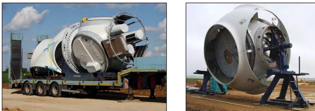
Figures 31 : Hub V90 et Nose-cone en attente de déchargement / Hub V112 en cours de préparation
