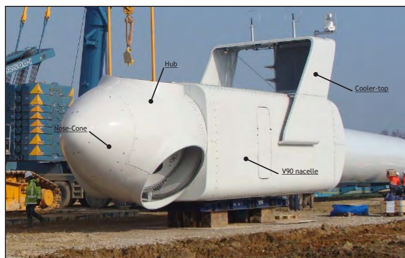
Figure 32 : Nacelle V90 avec hub, Nose-cone et Cooler-top équipés avant levage
