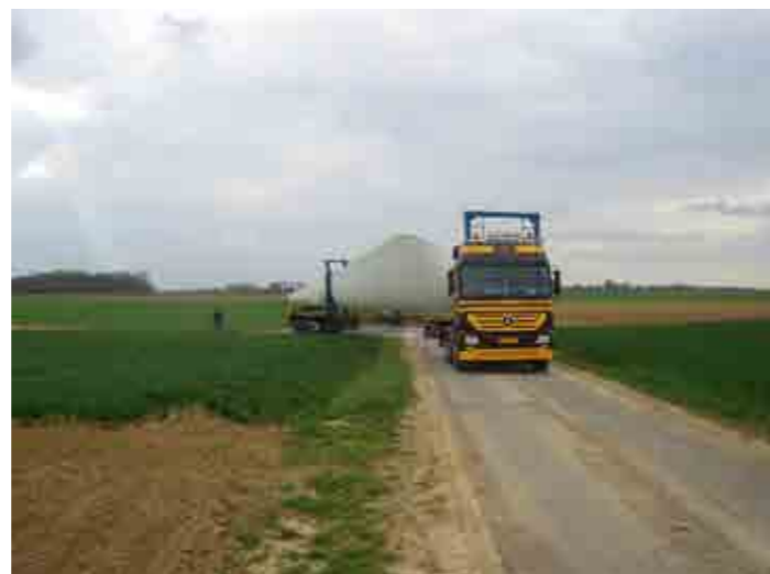
Photographie 6 : Transport d'une pale de 40 m
