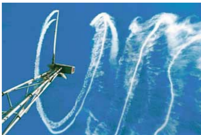
Photographie 67 : Effet de sillage derrière une éolienne (source : Windpower)
