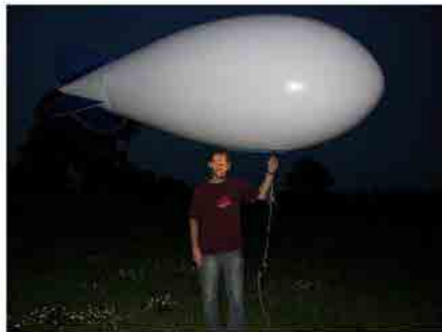
Photographie 77 : Ballon sonde météorologique utilisé pour des sondages en altitude des déplacements de Chiroptères (Source : O2 Environnement)
