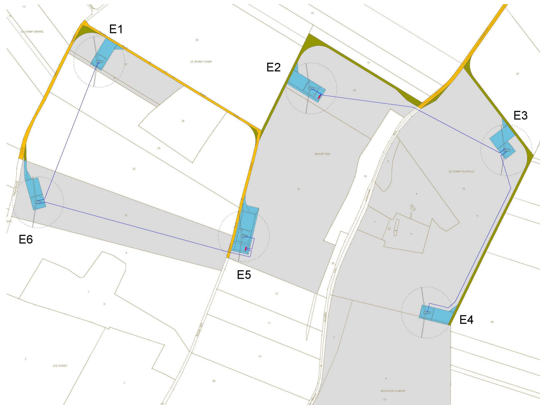
Figure 12 : Cheminement du raccordement électrique inter-éoliennes pressenti
